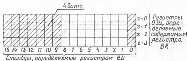
Рис. 5. Структура OЗУ однокристальных микроЭВМ КР1820ВЕ1 и КР1820ВЕ2: заштрихованная область OЗУ адресуется байтовой командой LВ1
